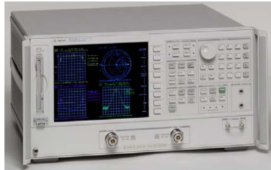
Figure 6 : Analyseur de réseau vectoriel
